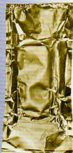
B: Anwärmen auf Härtungs- temperatur
