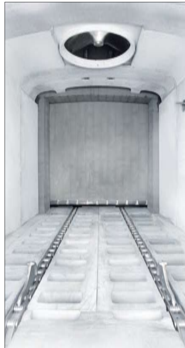
Heizkammer mit Ketten-transportsystem eines Mehrzweckkammerofens
