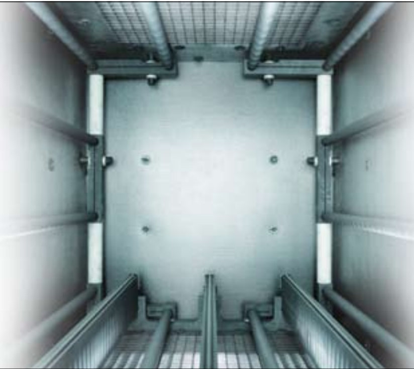
Die Heizkammer eines Turbo® Treaters mit neuentwickelten Gasführungsrosten
