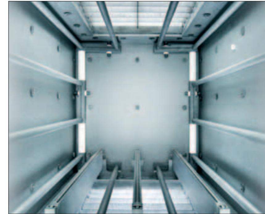
Die Heizkammer mit neuentwickelten Gasführungsrosten.
