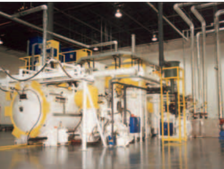
Drei-Kammer-Durchlauf-Vakuum- Lötöfen für die Großserienproduktion
