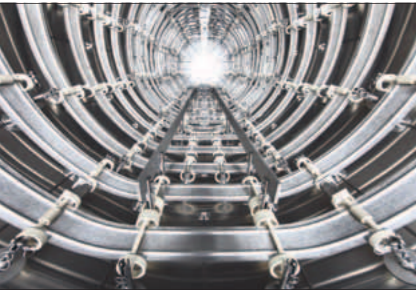
Die neue metallische Heizkammer für das Hart- und das Hochtemperaturlöten
